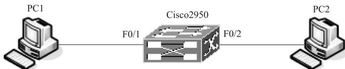
图 4-1 基于端口划分的 VLAN 配置拓扑图
