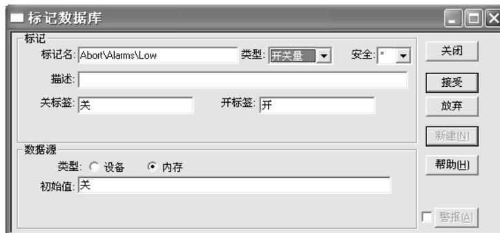
图 1.115 开关量参数的设置
