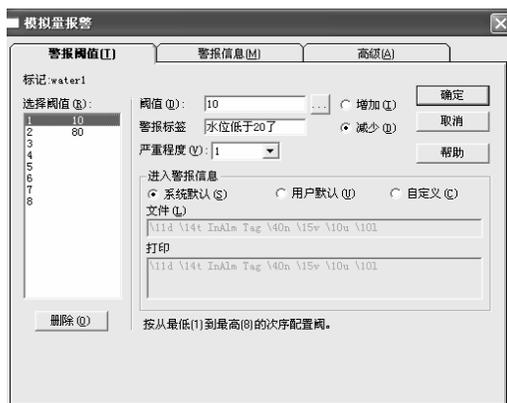
图 1.79 water1 低水位报警设置
