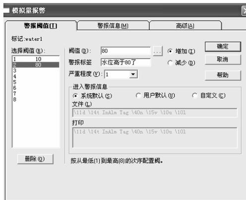
图 1.80 water1 高水位报警设置
