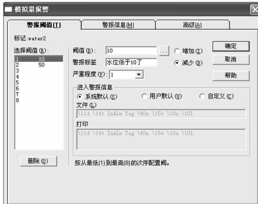
图 1.81 water2 低水位报警设置
