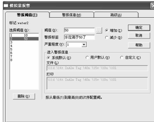
图 1.82 water2 高水位报警设置
