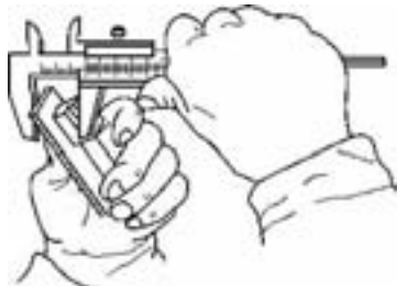
图 2-32 用游标卡尺测量刀尖高度
