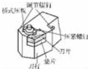
图 2-4 机械夹固式可重磨车刀
