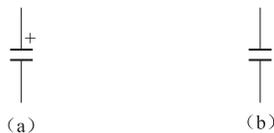
图 3-8 固定电容器在电路中的符号
