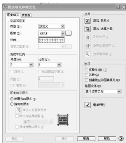
图 2-13 “图案填充和渐变色”对话框
