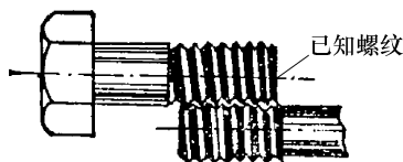
图 2-52 用已知螺旋测定公、英制螺纹的方法
