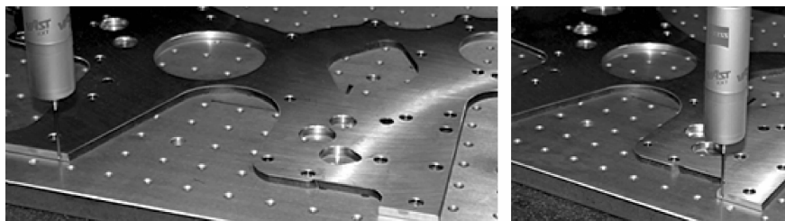
图 2.2-5 三坐标测量仪检测零件侧面精度
