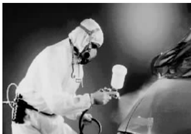
图2-4 涂装车间个人安全防护
