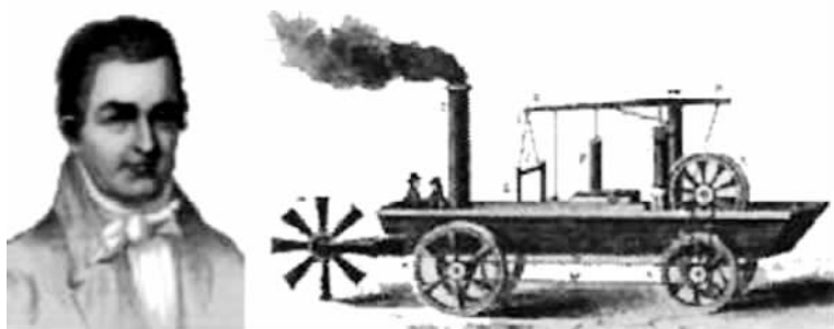
图2-12 埃文斯和他制造的水陆两用蒸汽汽车
