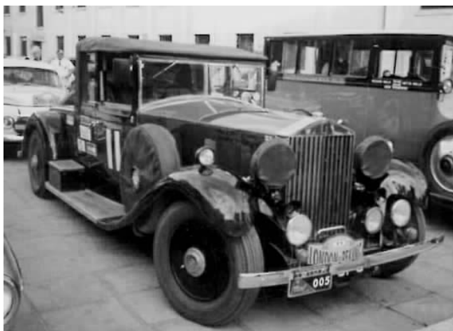
图2-35 “幻影Ⅲ”（1936问世，采用12缸发动机，时速100 mile（1 mile = 1 609.34 m）。）
