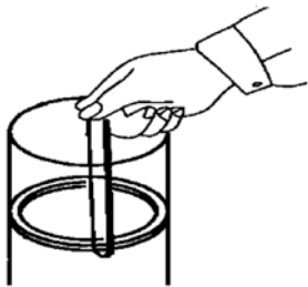
图 2-5 活塞环端隙的测量
