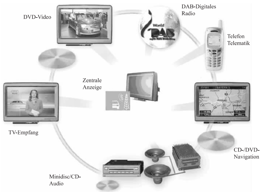
图 2-9 奥迪 A6、A8 轿车 MOST 总线环形网络拓扑结构
