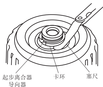
图 2-28 测量卡环与起步离合器 导向器之间的间隙
