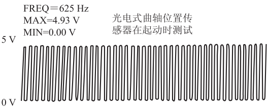
图 2.73 光电式曲轴位置传感器信号波形
