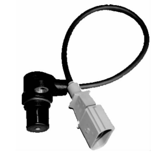
图 2.60 磁脉冲式凸轮轴/曲轴位置传感器
