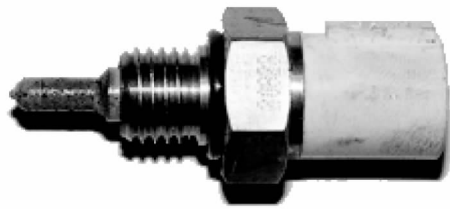
图 2.56 进气温度传感器外形图
