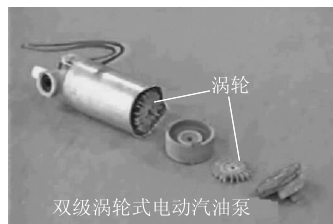
图 2.19 涡轮式电动燃油泵
