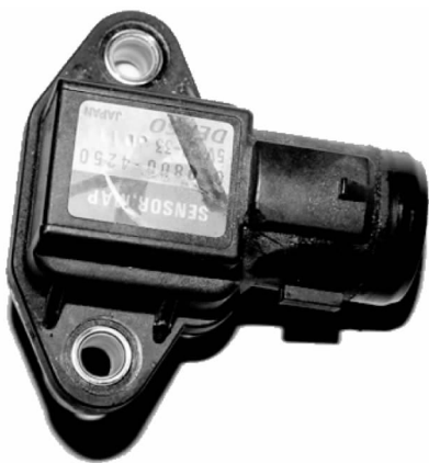
图 2.45 进气歧管绝对压力传感器外形图
