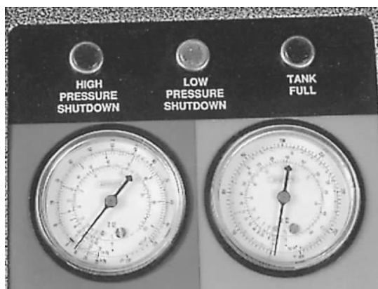
图片 3-8 至少观察压力表 5 min。如果真空没有升 高，那么完成了制冷剂的回收。如果真空升高，并 且保持在 0 psig（即 0 kPa）或者更低，那么表明 系统存在渗漏。完成制冷剂的回收，并且维修系统
