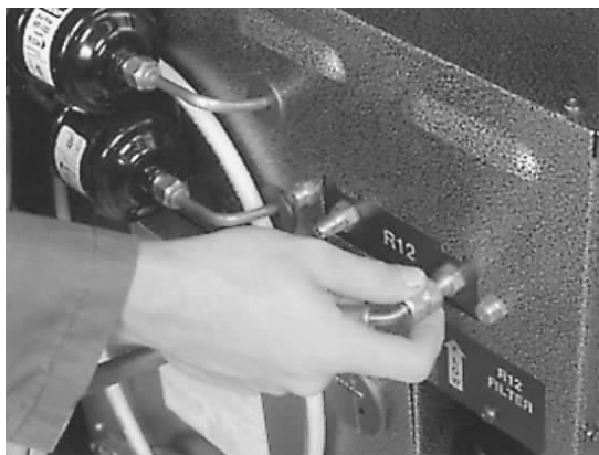
图片 3-1 把歧管压力表组连接到制冷剂回收系统上
