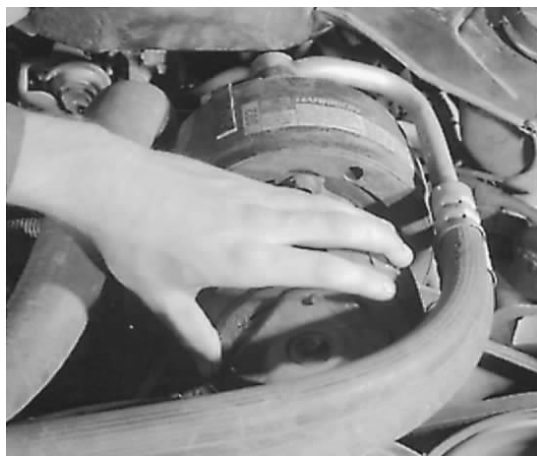
图片 4-3 用手转动压缩机离合器 2~3 圈, 从而确保液态制冷剂没有进入压缩机的低压侧
