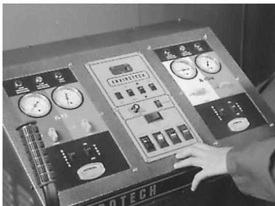
图片 3-12 从系统维护阀或者接头上，拆下所有的软管。盖上所有的接头和软管，防止灰尘、外来物质或者水汽进入系统。对于 R134a 系统，这个是非常重要的。系统所用的润滑剂是非常容易吸湿的
