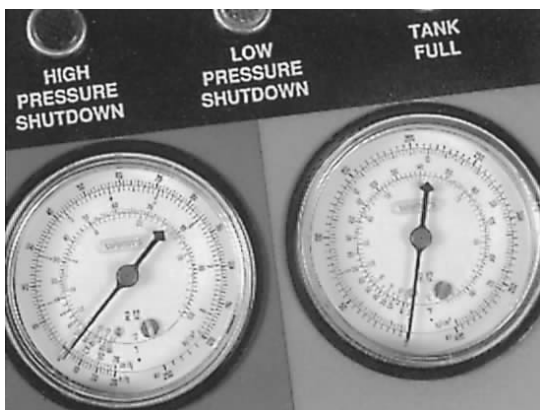
图片 3-9 如果真空升高到正的压力，即大于 0 psig （即 0 kPa），那么就是系统中的制冷剂没有完全 去除。从图片 3-5 的程序开始，重复进行回收程序
