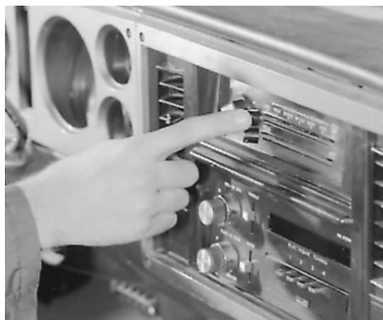
图片 4-8 关闭所有的空调控制装置
