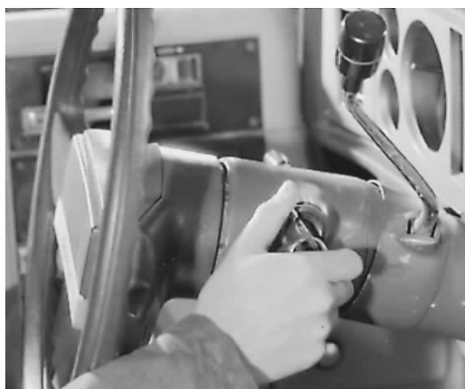
图片 4-9 把发动机怠速降低到正常的转速。使发动机停止运转
