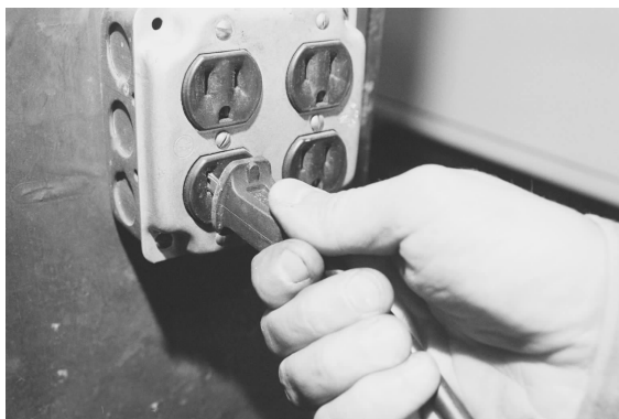
图片 3-4 把制冷剂回收系统连接到合格的电源上
