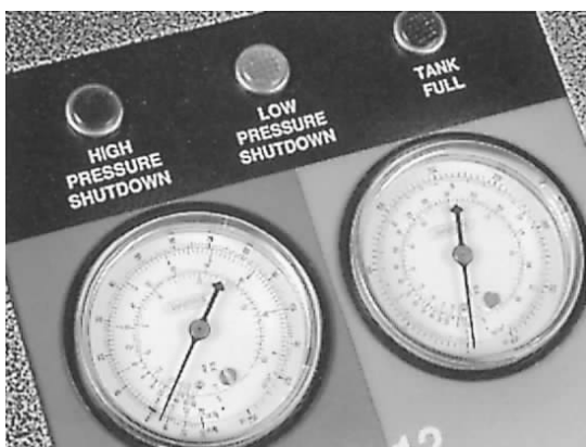
图片 3-7 使回收系统运转，直到出现真空压力。 回收系统将会自动关闭。如果没有安装自动 关闭装置，那么在达到真空压力以后，把 压缩机开关转到 OFF 位置
