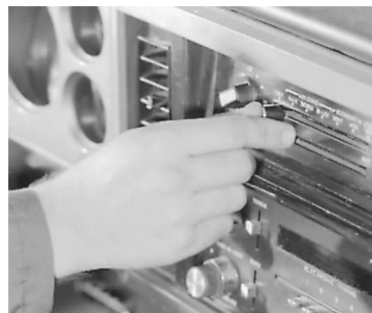
图片 4-6 把所有的控制装置设定在最大制冷位置。打开歧管阀和软管截止阀, 以便开始制冷剂的加注
