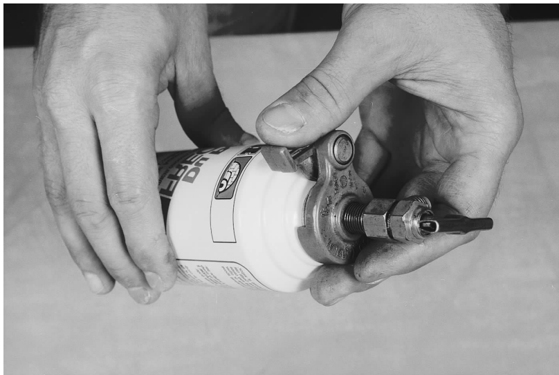
图 3-6 安装磅罐放液阀
