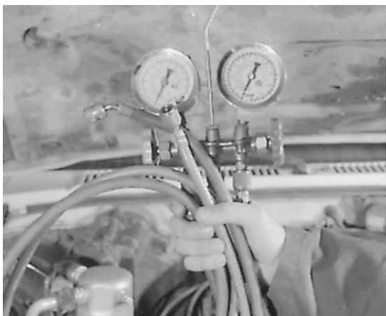
图片 4-11 从系统上拆卸歧管压力表组
